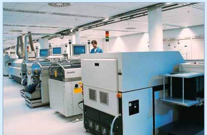
SMD-Bestückungslinie mit automatischer Nutzentrennung
