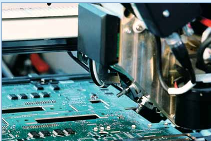
SMD-Leiterplatten Bestückung mit automatischer visueller Kontrolle
