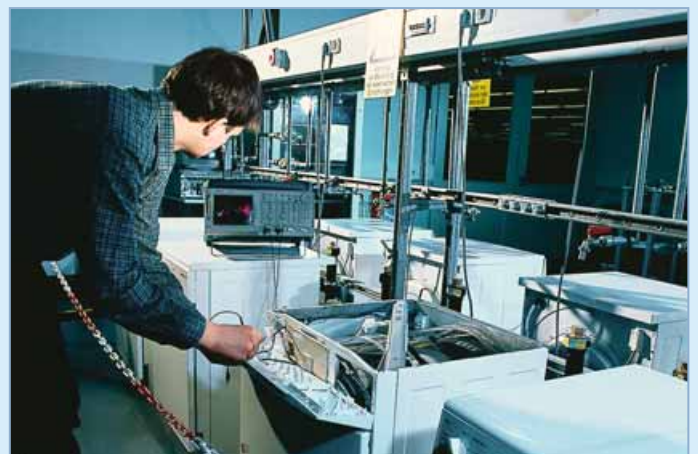
Serienbegleitende Lebensdauer- und Zuverlässigkeitstests an Elektronikbaugruppen für Trockner
