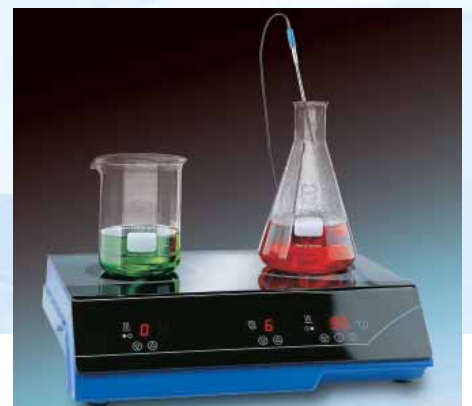
Multi-Modul in einem Laborkocher mit Rührersteuerung
